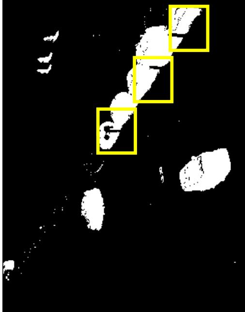
die Grauwerte im Übergangsbereich zwischen Fahrzeug und Hintergrund ändern sich langsam und kontinuierlich und werden adaptiert, verlässt die gerade Objektkante die betreffenden Pixel dann wird der Sprung vom adaptierten Grauwert zum Hintergrundgrauwert als Objekt interpretiert: Geisterkanten
