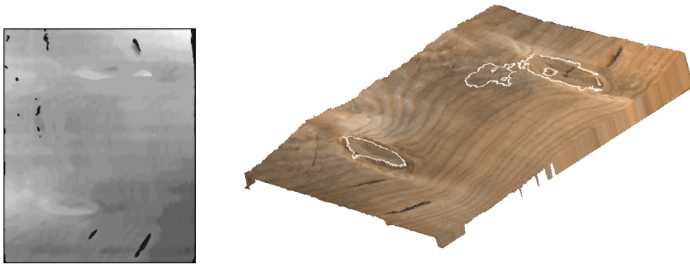
Abb. 5: Tiefenkarte (links) sowie 3d-Fusion der Tiefenkarte mit rekonstruiertem RGB-Bildeinzug und dem Ergebnis der Astsegmentierung (rechts)
