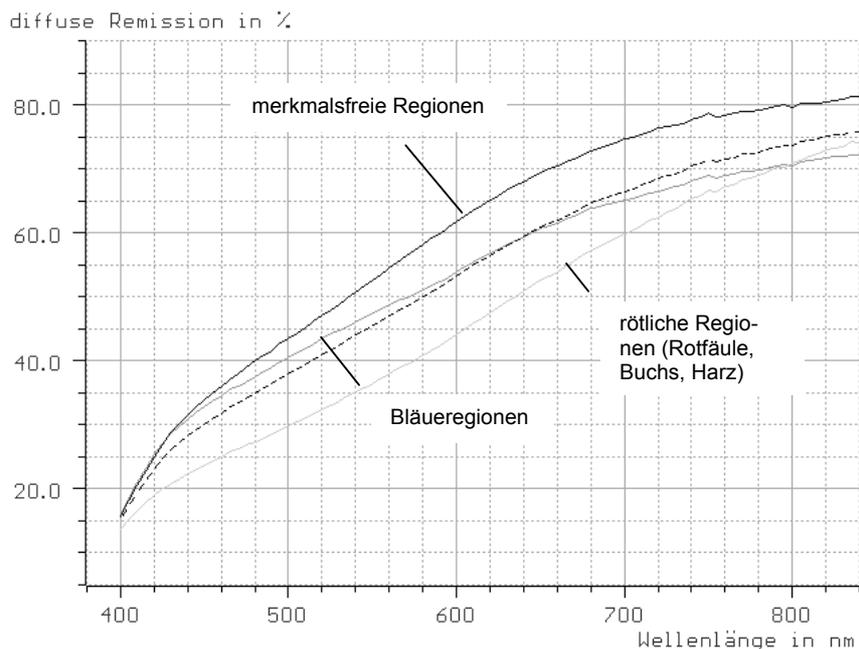
Abb. 1: Mittlere Remissionskurven für typische Farbregionen von Fichtenholz
