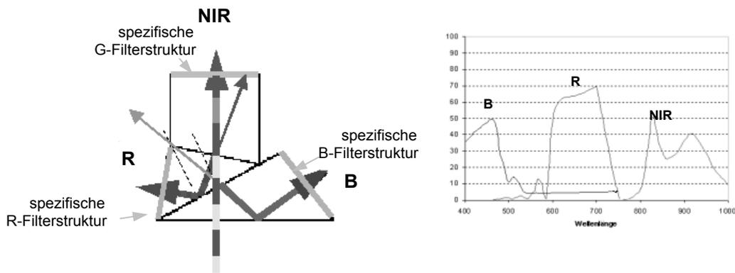
Abb. 2: Realisierung der Sensorempfindlichkeit durch Modifikation des Strahlteilers
