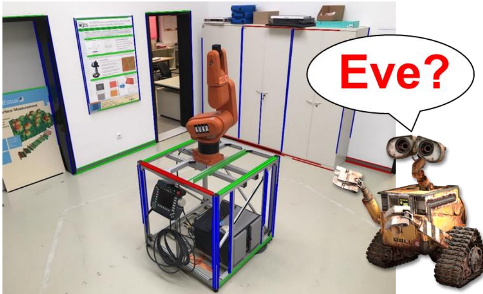
Abb.: Demonstrator für MRK im ZBS e.V.. Die im Bild erkannten Liniensegmente sind farblich (rot, grün, blau) entsprechend der Achsenrichtungen der Manhattan-Welt gekennzeichnet.
