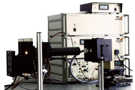
Bild 5: Messplatz Doppelmonochromator für Remissions- und Transmissionsmessungen
