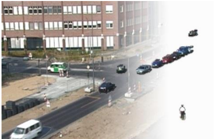
Bild 3: Trennung von Vorder- und Hintergrund in Verkehrsszenen
