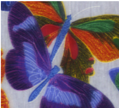
a.) Druckrapportverschiebung (z. B. gelb und rot)
