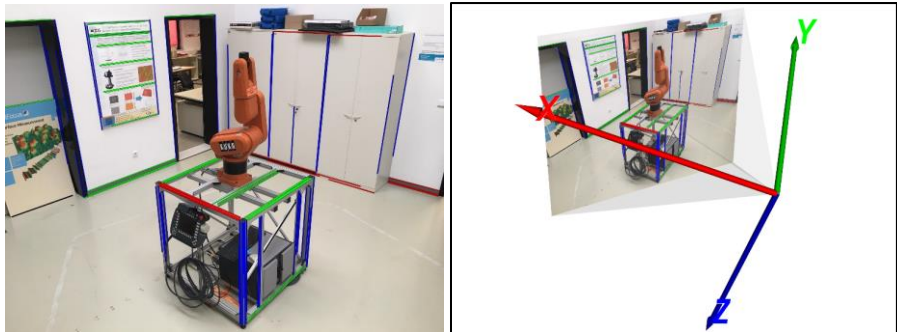
Abb. 1: Demonstrator für eine MRK im ZBS e.V.. Die im linken Bild segmentierten Liniensegmente sind farblich entsprechend der zugeordneten Achsenrichtungen eines Manhattan-Weltmodells dargestellt. Das Bild rechts zeigt ein Weltkoordinatensystem, das aus Bildmerkmalen Fluchtpunkten abgeleitet werden kann.
