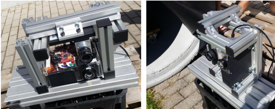
Abb. 3. Laborversion des aktiven Stereo-Messsystems; links einzeln (Kamera oben, Projektor unten); rechts zusammen mit einem Teil des Messobjekts
