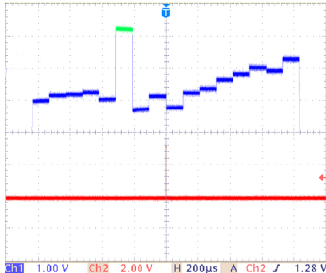
Abbildung 3: Erfasste mehrkanalige Sensorsignatur einer Leuchte mit spektral breitbandiger Lichtzusammensetzung aus Kanalantworten des plasmonischen Sensormoduls.
