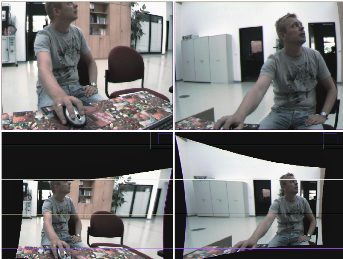
Abb. 6.4: Ergebnis der Bildentzerrung und Rektifizierung mit eingezeichneten Epipolarlinien (unten) der Eingabebilder (oben).
