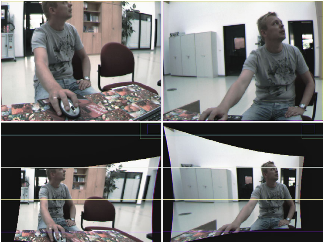
Abb. 6.5: Ergebnis der Bildentzerrung und Rektifizierung mit eingezeichneten Epipolarlinien (unten) der Eingabebilder (oben).
